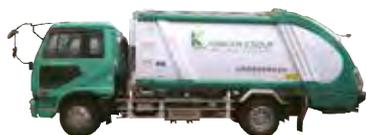
圧縮型の積み込み車輦です。重量が軽く圧縮できる廃棄物を大量に積み込むことができます。
