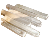
溶融処理された発泡スチロール
